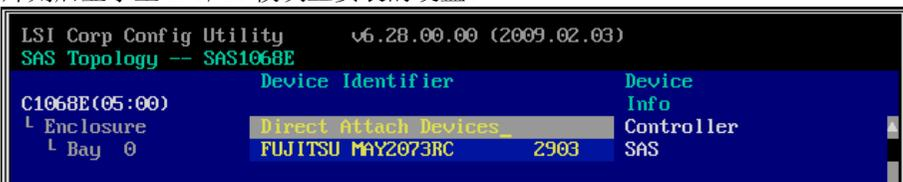
4. 选择要进行物理格式化的硬盘，同时按下 **D** 键和 **Alt** 键。片刻后显示“Device Properties”菜单。
