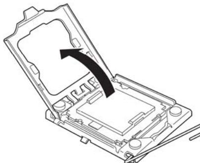
9. 打开 CPU 插槽的盖板。
