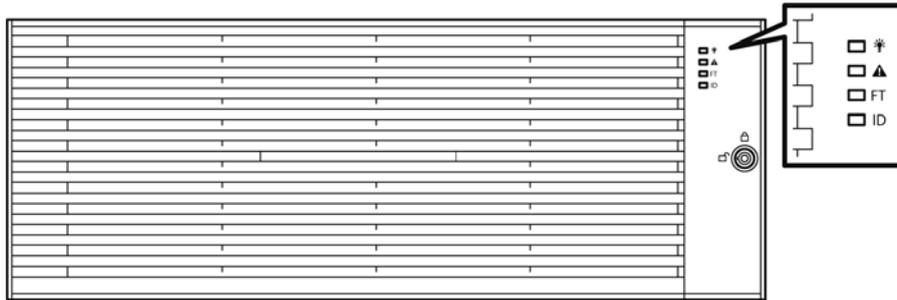
安装在 2.5 英寸硬盘托架上的硬盘驱动器的指示灯。
