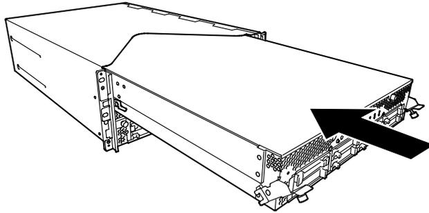
2. 向上推动 CPU/IO 模块前端左右两侧的黑色拉杆，用螺丝将其固定。
