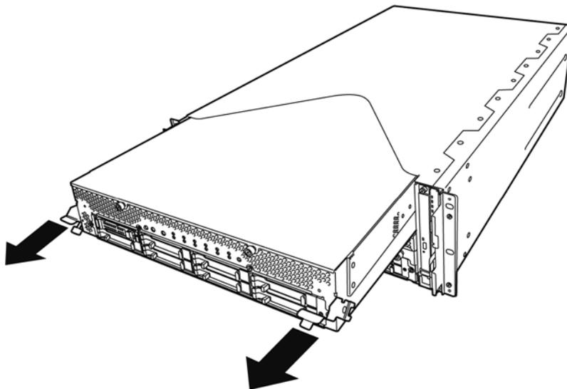
6. CPU/IO 模块在中途被锁住，无法拉出时，降低 CPU/IO 模块侧面的锁杆将其解锁并拉出。
