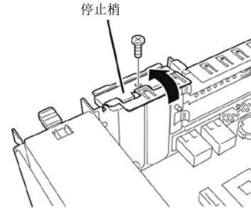
5. 卸下固定转接卡的三颗螺丝，从母板上拆卸转接卡。
