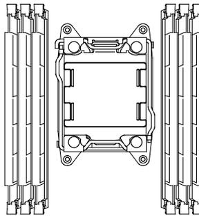
8. 向下推标有"
