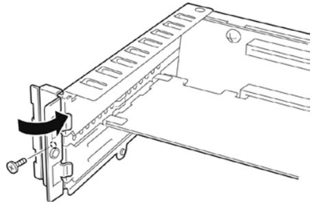
11. 在母板上安装转接卡并用三颗螺丝固定。
