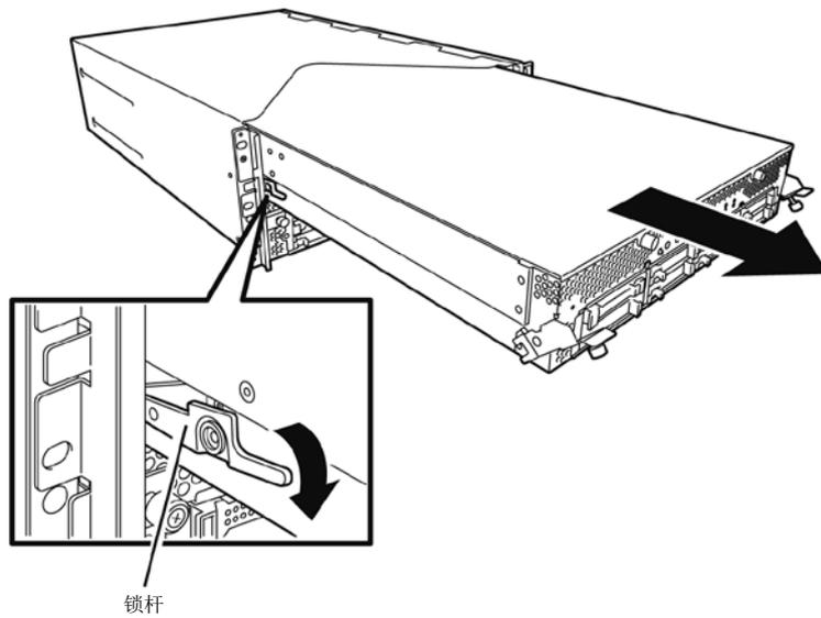
7. 轻轻拉出 CPU/IO 模块，将其放置在平坦结实的桌子上。
