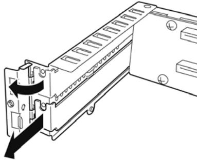
9. 在 PCI 插槽中安装 PCI 板卡。
