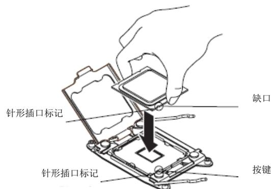
12. 轻轻将处理器推到 CPU 插槽中，并关闭盖板。
