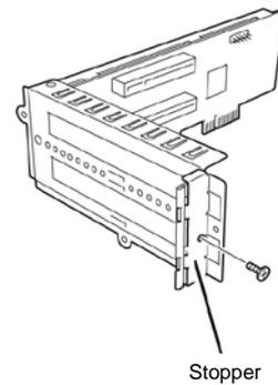
8. 拆卸 PCI 支架盖板。
