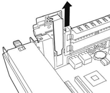
7. 在 PCI 插槽中安装 PCI 板卡。
