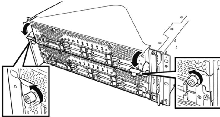
5. 握住 CPU/IO 模块的黑色拉杆将其拉出。
