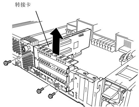
6. 卸下固定停止梢的一颗螺丝，从转接卡上卸下停止梢。
